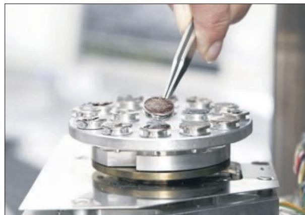
Auftragsbearbeitung: Auf dem oberen Foto ist eine eingesandte Probe zu sehen, die auf Asbest untersucht werden soll. Das untere Foto zeigt mehrere Proben, die bereits für die Analyse mit dem Rasterelektronenmikroskop vorbereitet wurden. 2 Fotos: CRB/jnh
